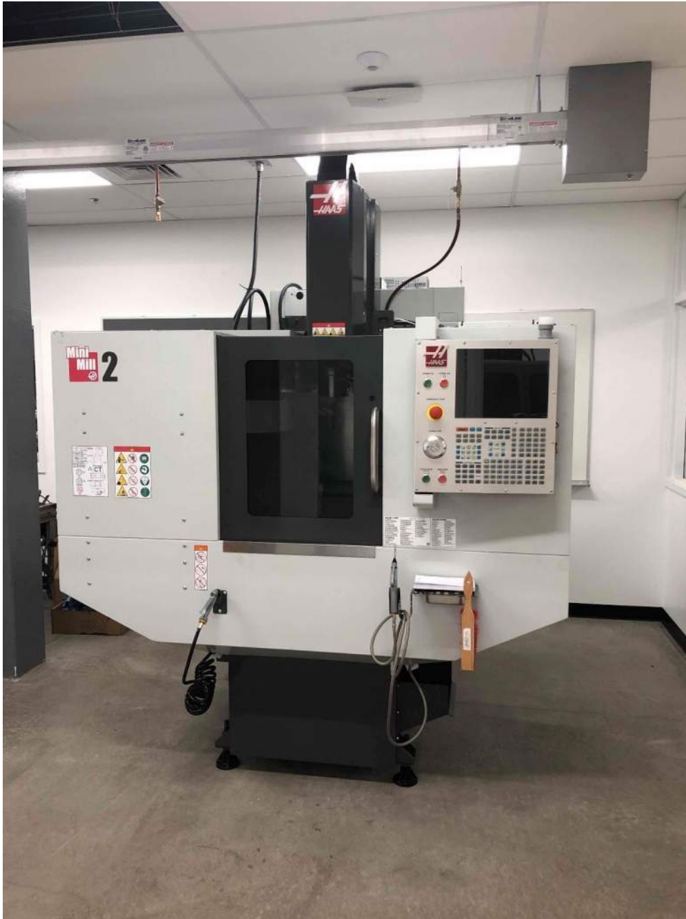
Mini Mill Installed
